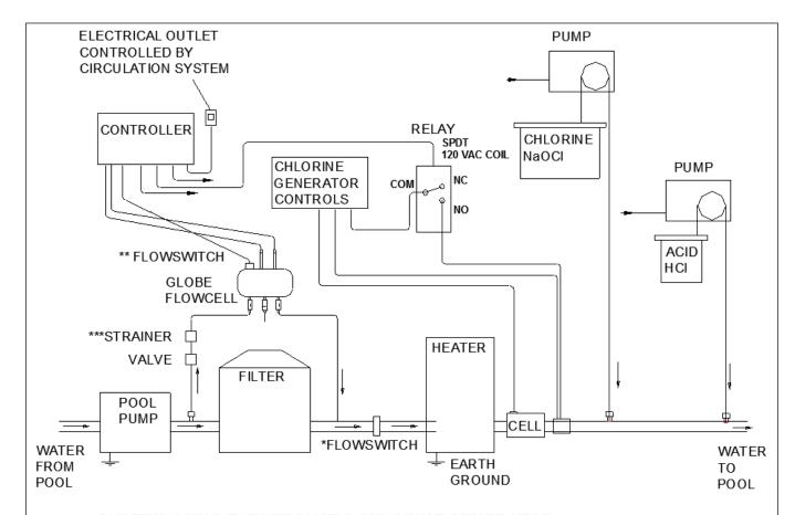
SYSTEM USING ELECTROLYTIC CHLORINE GENERATOR
